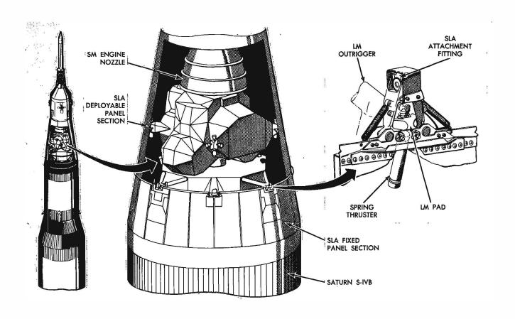
Figure 2-7. LM Interface With SLA
